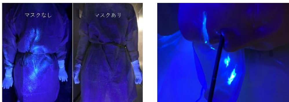
(写真2：(左) 蛍光塗料の汚染をマスク未装着と装着の場合で比較。 (右) マスクを装着したマネキンでは蛍光塗料がマスク内のみ留まった。)
